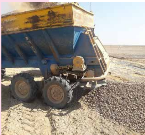
شکل ۴. الف) پاشش سنگریزه با استفاده از کمپرسی؛ ب) عدم یکنواختی در پاشش سنگریزه با استفاده از کمپرسی؛ ج) پاشش سنگریزه با استفاده از کودپاش اصلاح شده؛ د) یکنواختی نسبی در پاشش سنگریزه با استفاده از کودپاش اصلاح شده
